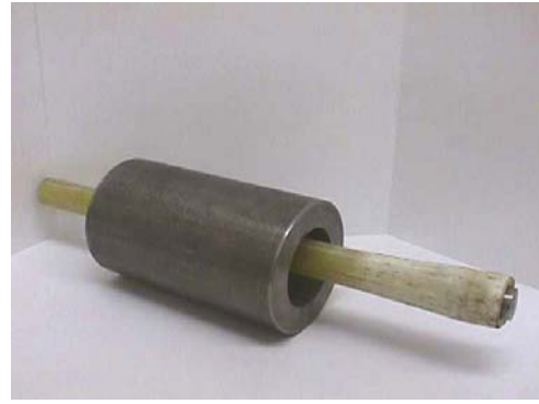
(d) Anchoring of the bar in the chuck
