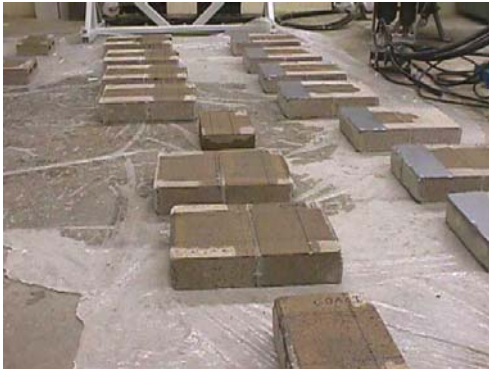
(a) Application of primer
