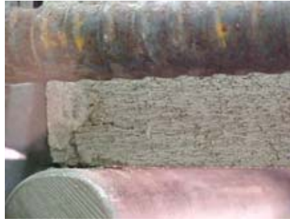
(d) CG3 – Crushing of the tile
