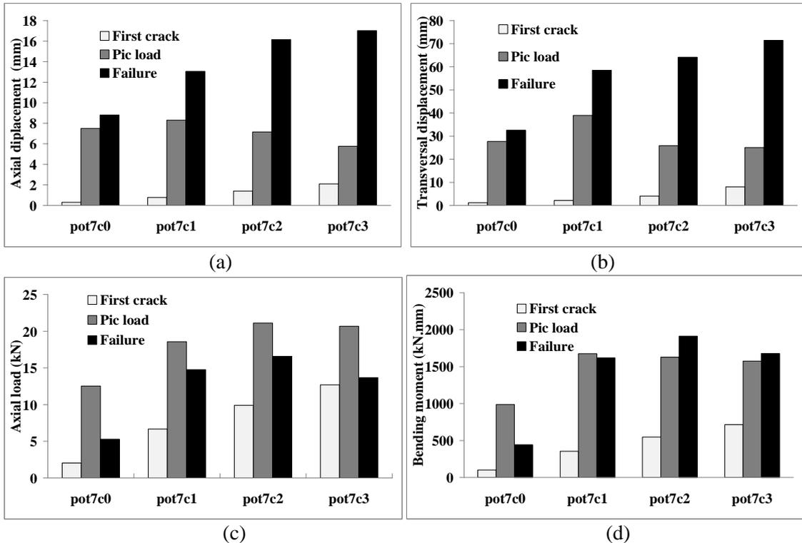
Figure 8. Experimental  $\delta_z$  (a),  $\delta_t$  (b),  $N$ (c) and bending moment  $M$  (d) values at points 1, 2 et 3.
